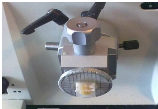
Zdjęcie 3. Przycięty bloczek przyklejony do holdera
